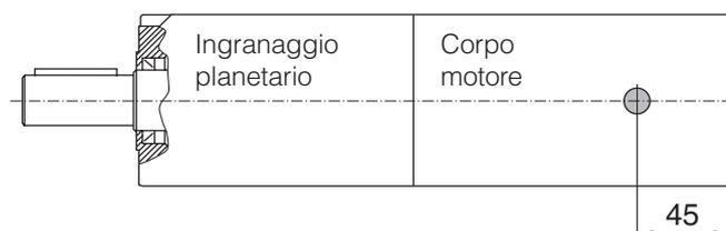
La temperatura max. sull'esterno si raggiunge dopo circa 1,5 ore di esercizio. L'aumento di temperatura rispetto alla temperatura ambiente non deve superare 55 °C.
