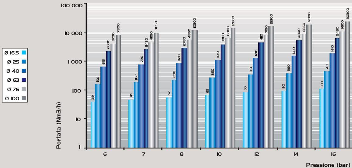
Performance della portata dei diametri TRANSAIR® in funzione della pressione di servizio per una perdita di carico di 0,1 bar
