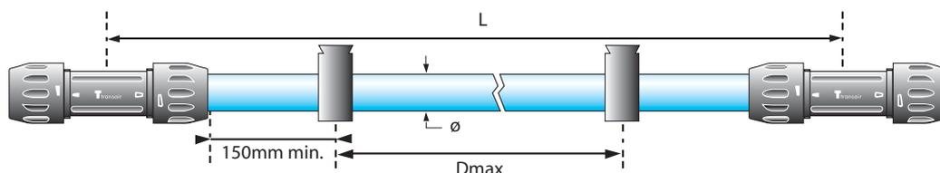
La clip di fissaggio Transair® è il componente di base nel fissaggio di una rete Transair® in alluminio nei Ø 16,5 – Ø 25 – Ø 40 – Ø 63. E' importante utilizzarla perchè permette di lasciare libero corso ai fenomeni di dilatazione e di contrazione.
