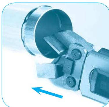
Aprire manualmente le 2 ganasce della pinza. Inserire il tubo in alluminio nella pinza fino a battuta.
