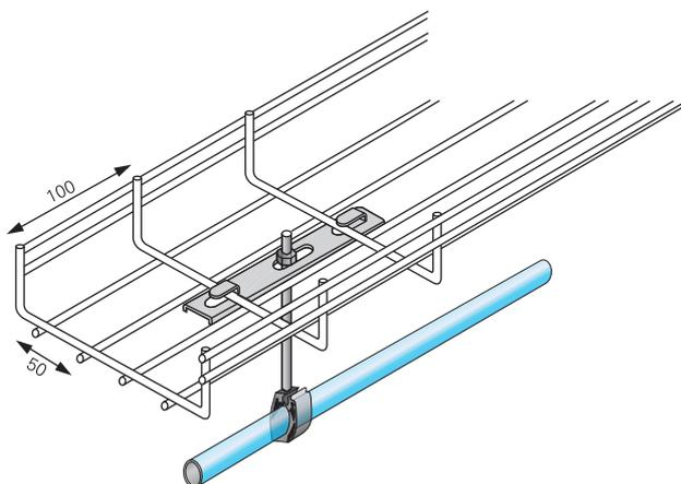
Utilizzare il fissaggio sotto canalina a filo portacavi 6699 10 03. L'apertura oblunga 10x30 può accettare il passaggio di barre filettate fino a M10. Questo sistema permette di sospendere reti dal  $\varnothing$  16,5 al  $\varnothing$  100.
