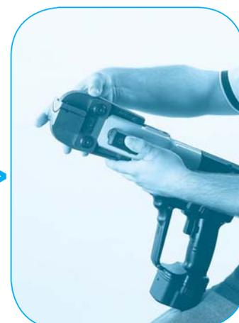
Posizionare la pinza nel suo alloggiamento.
