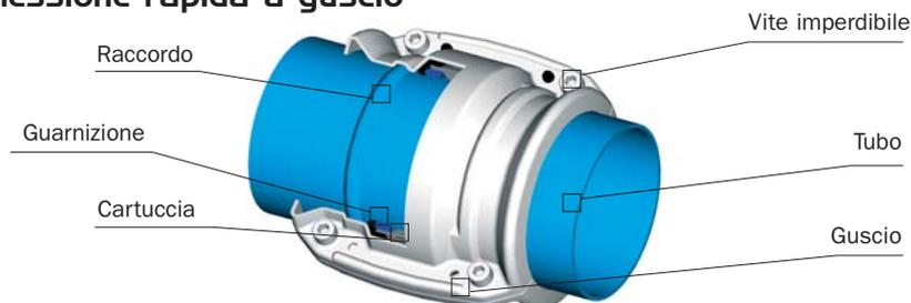
I raccordi Ø 76 e Ø 100 si connettono immediatamente al tubo in alluminio Transair®. E' sufficiente posizionare i tubi da collegare nella cartuccia Transair® (elemento che permette di realizzare la tenuta fluidica) per
