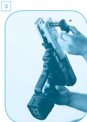
3 - Realizzazione di una connessione di tubo Ø 76 o Ø 100 tagliato
