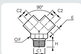
**Y pari femmina BSP cilindrica, maschio BSP conico**
