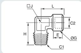
**Gomito femmina, BSP cilindrico, maschio BSP conico**
