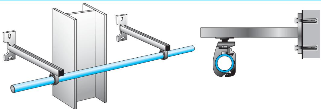
Le mensole modulari Transair® permettono di spostare le reti e di aggirare gli ostacoli. Sono composte da una barra profilata 6699 01 01, e da un kit di accessori di fissaggio 6699 01 02.
