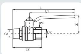
**Rubinetto maschio BSP conico - femmina BSP cilindrico**
