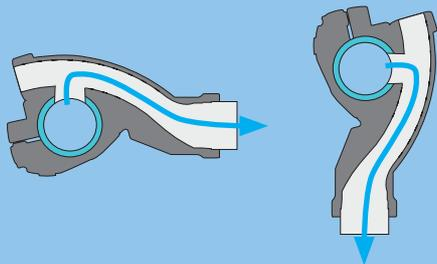
Le bredie di derivazioni "posa rapida" nuova generazione permettono di realizzare delle discese rigide o morbide, verticali o orizzontali.
