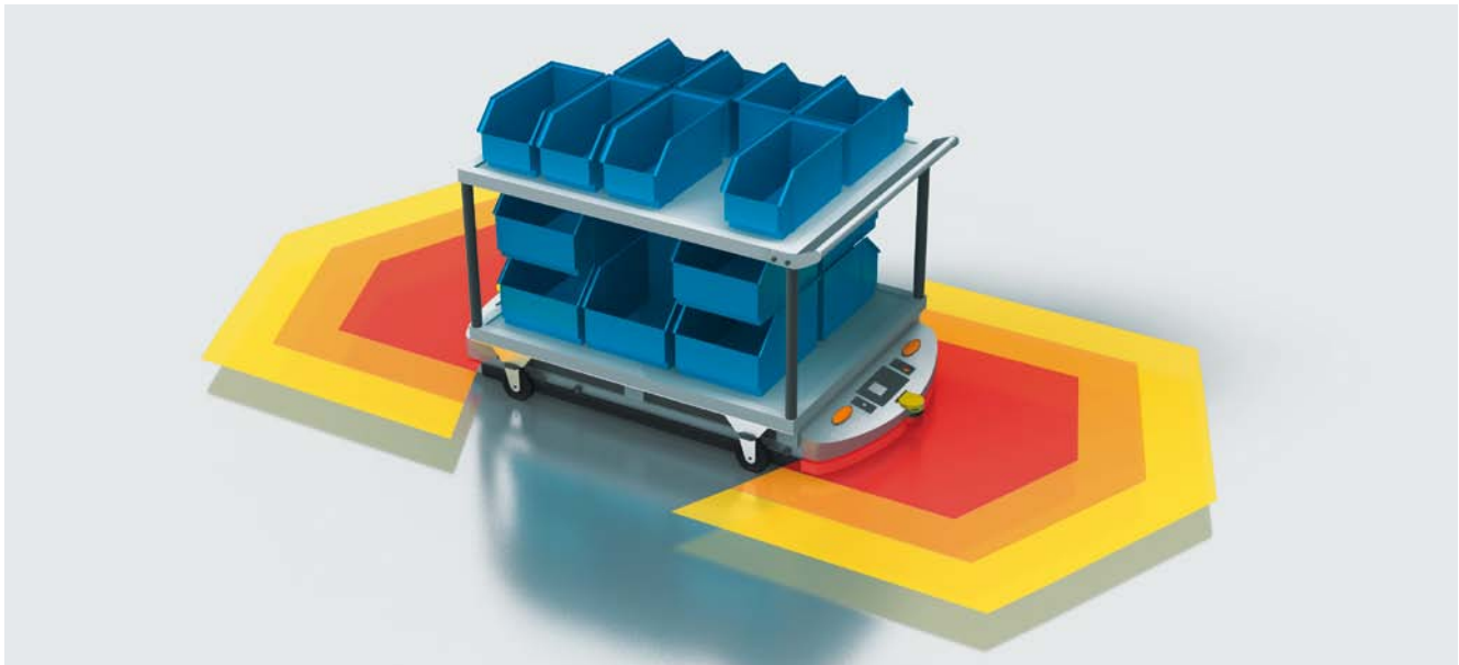
Applikationsbeispiel: Absicherung eines Kleinfahrzeugs mit zwei S300 Mini
