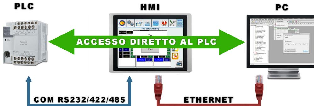
Il software PM Designer permette di utilizzare l'HMI come un convertitore Ethernet-to-serial e di utilizzare questa porta COM-Virtuale per far comunicare il software del PLC con il PLC attraverso l'ethernet del pannello.
